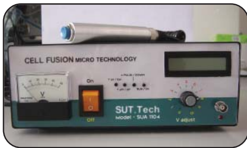
รูปที่ 7 เครื่องเชื่อมเซลล์ด้วยไฟฟ้ากระแสตรง
