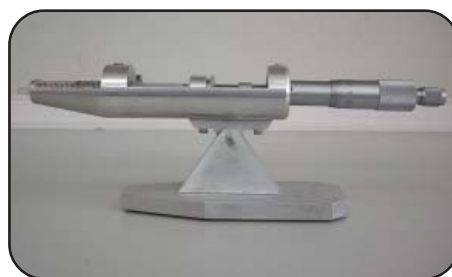
รูปที่ 8 อุปกรณ์ควบคุมการเคลื่อนที่ก้านสูบของไมโครไซริงก์
