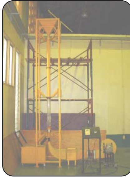
รูปที่ 9 เครื่องอบแห้งแบบการไหลสวนทางในแนวตั้ง
